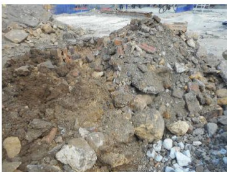
Remblais sableux marron grisâtre avec quantité importante de déchets de déconstruction (S43)
